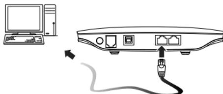
Quando a conexão entre o dispositivo e o computador for configurada, o indicador de LAN correspondente do dispositivo será ligada.
